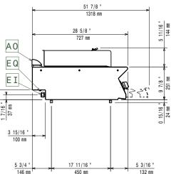
Electrical inlet (power) EQ **Equipotential screw**
